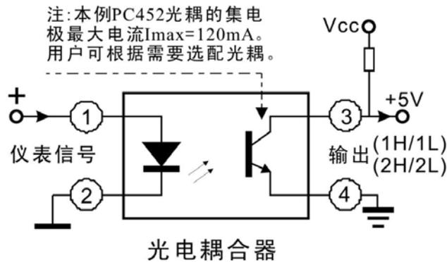
4、由于光敏三极管  $I_c$  最大电流的限制，其扩流和驱动负载能力有限，用户如需更大驱动电流，用来现场驱动继电器、电磁阀、步进电机等装置，可自行外接功率扩展电路（功率放大管或伺服电路）进行扩流放大处理或做特殊定制。
